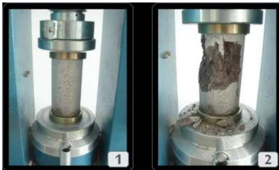
Figura 14 - Ensaio de Resistência a Compressão
