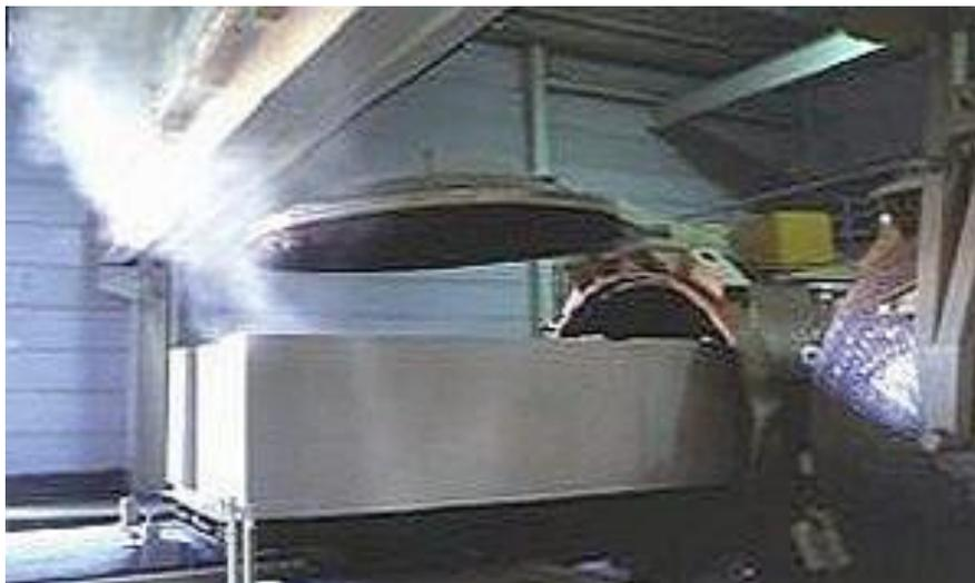
Figura 7 - Cura térmica do concreto pré-moldado
