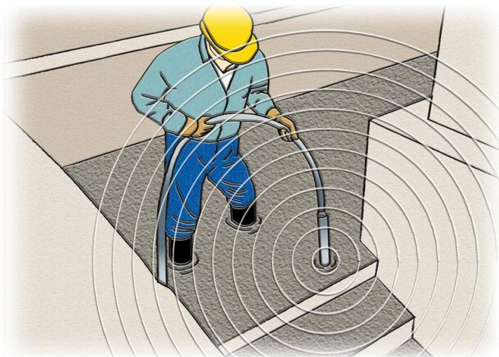
Figura 3 - Adensamento do Concreto com vibrador de agulha
