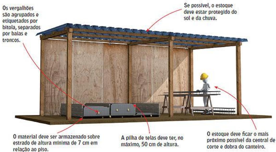
Figura 12 - Armazenamento de aço
