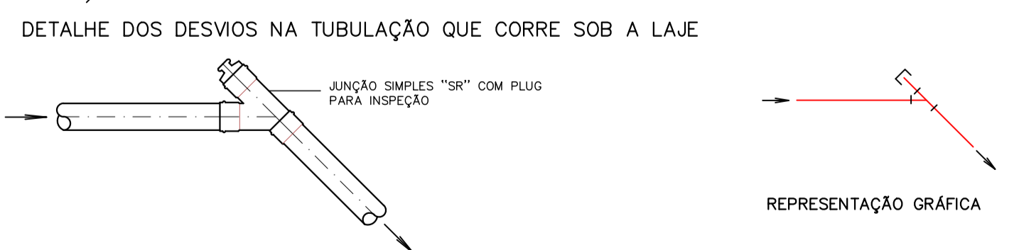
DETALHE DOS DESVIOS NA TUBULAÇÃO QUE CORRE SOB A LAJE
