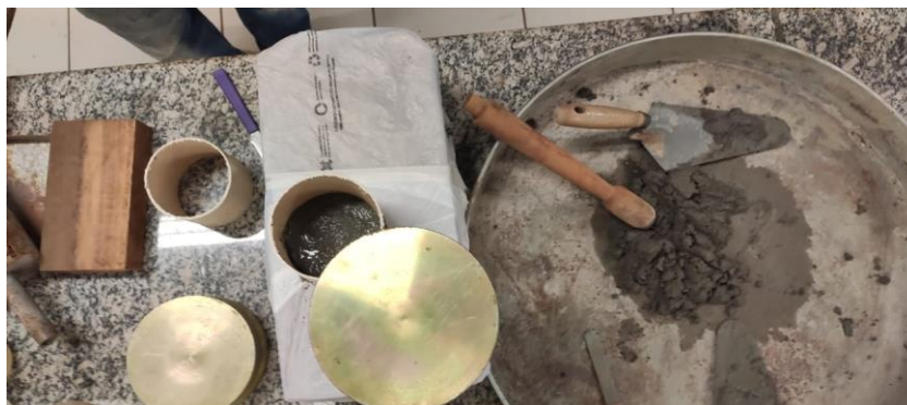
FIGURA 2 – Execução dos corpos de provas
