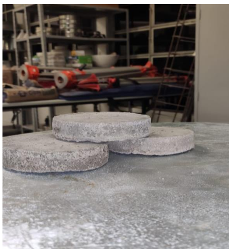
FIGURA 3 – Corpos de prova de concreto
