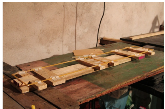
Gabarito de formação das vigas
